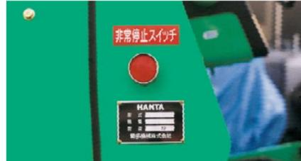
本機は、エンジンを緊急停止する非常停止スイッチを本体左右2ヶ所、運転席操作パネルに1ヶ所設け、安全性を向上しています。
