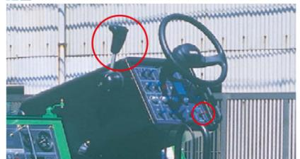
走行レバー及び自動・手動切替スイッチ/作業・走行スイッチ停止がONの時は、エンジンは始動しないシステムになっています。
