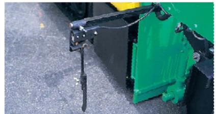
スクリュより左右に送られる合材量をフレーム後部の両サイドに設けた検知センサーによりフィーダ、スクリュの駆動と連動し、自動制御ができます。
