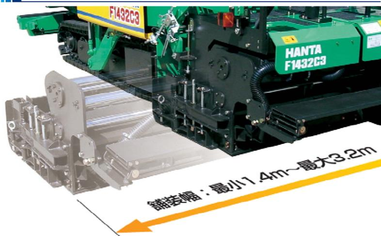
1.4mから3.2mまで無段階伸縮が可能なスクリーンです。施工中に舗装幅が変更できるという便利さだけでなく、高い剛性で、高い舗装品質を約束します。
