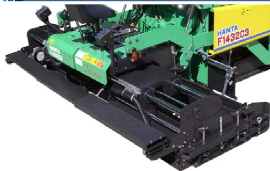
スクリーンには、3.2m幅いっぱいにも本格的なステップを設置し、施工幅最端部まで移動できます。
