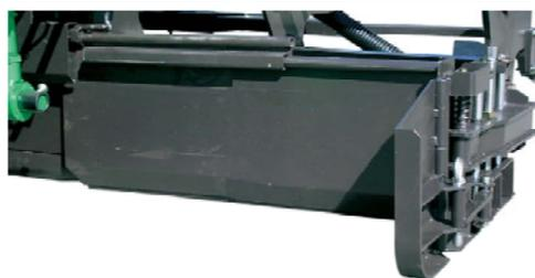
伸縮式モールドボードによりリアスクリーン前への余分な合材の抱え込みを防ぎ、スクリーン端部への合材送りもスムーズ。施工中にも、合材溜り量の調整が可能です。
