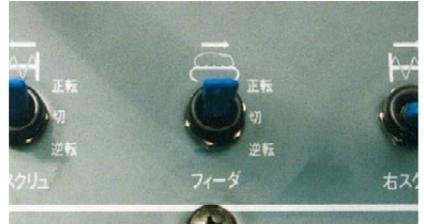
路盤材がフィーダに噛み込んだ時は、スイッチ操作によりフィーダを逆転して外せます。
