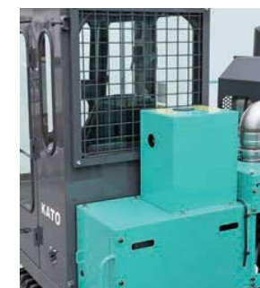
エンジン冷却水タンク
