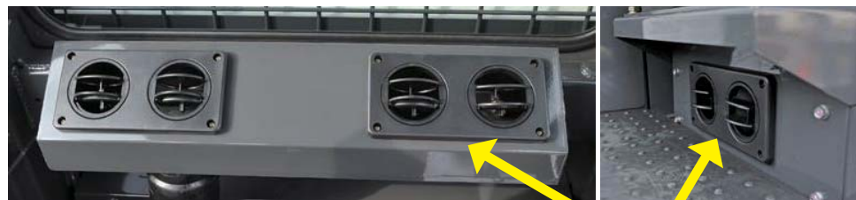
エアコンの排風口は座席後/座席下、足元の3箇所に設置し、足元部はデフロスタとして、活用可能です。
