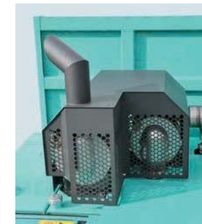
排ガス後処理装置
